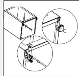
13. Stift des oberen Scharniers in das Loch der Gerätetür stecken.
