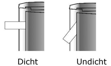
Die Gerätetürdichtung ist undicht, wenn sich das Papier leicht herausziehen lässt.
